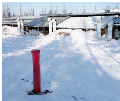
Рис. 8 Размещенные навесы, термометрические скважины и датчики теплового потока подземного нефтепровода
