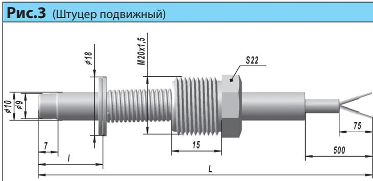
Диапазон измеряемых температур **-50...+150 °С**, Схема 4
