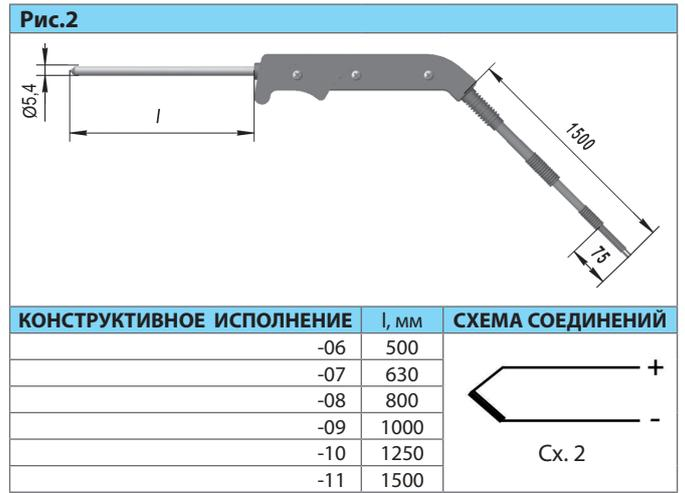
ПРЕОБРАЗОВАТЕЛЬ ТЕРМОЭЛЕКТРИЧЕСКИЙ ТПП 1701
