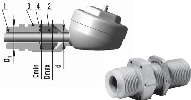
**Рис.1 для трубного монтажа электрической соединительной линии КМЧ 075001-00**
