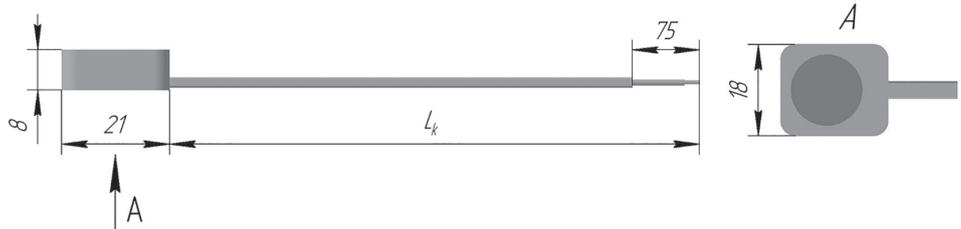
**ПОВЕРХНОСТНЫЕ ТЕРМОЭЛЕКТРИЧЕСКИЕ ПРЕОБРАЗОВАТЕЛИ ТХА 9712, ТХК 9712**
