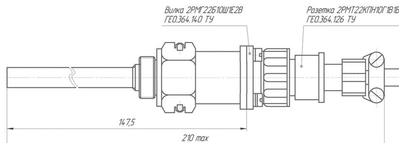
Рис. 2 Габаритный чертеж приемника П-1.01 (Остальное см. на рис. 1)
