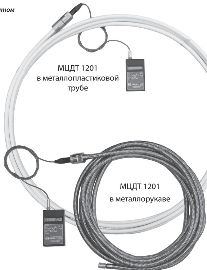
Датчик температуры многозонный цифровой МЦДТ 1201 преобразует измеренный сигнал в цифровой вид с последующей передачей его на устройство считывания, хранения и отображения данных – контроллеры цифровых датчиков портативные типа ПКЦД-1/100 или стационарные типа СКЦД-1/100 и СКЦД-6/200, или логгеры цифровых датчиков ЛЦД-1/100, или на другое совместимое с ним считывающее устройство. Допускается использование одного из устройств для работы с несколькими МЦДТ 1201.
