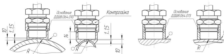
При установке ТСП 9508 на трубопровод основа ДДШ8.064.010 обработать под радиус R трубопровода. С помощью основания ДДШ8.064.013 устанавливается термопреобразователь на плоскость или на трубопровод радиусом R более 500 мм. Термопреобразователь завернуть до упора и затянуть контргайку.
