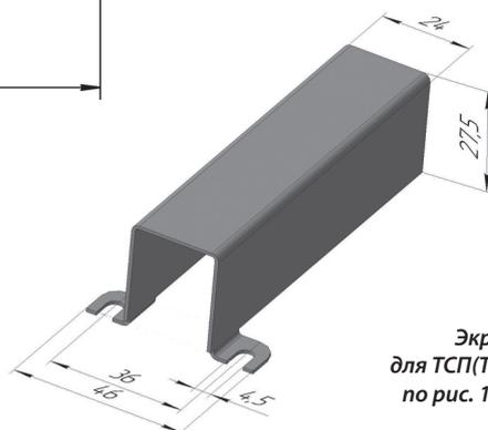
Экран для ТСП(ТСМ) 9417 по рис. 1 и рис. 2
