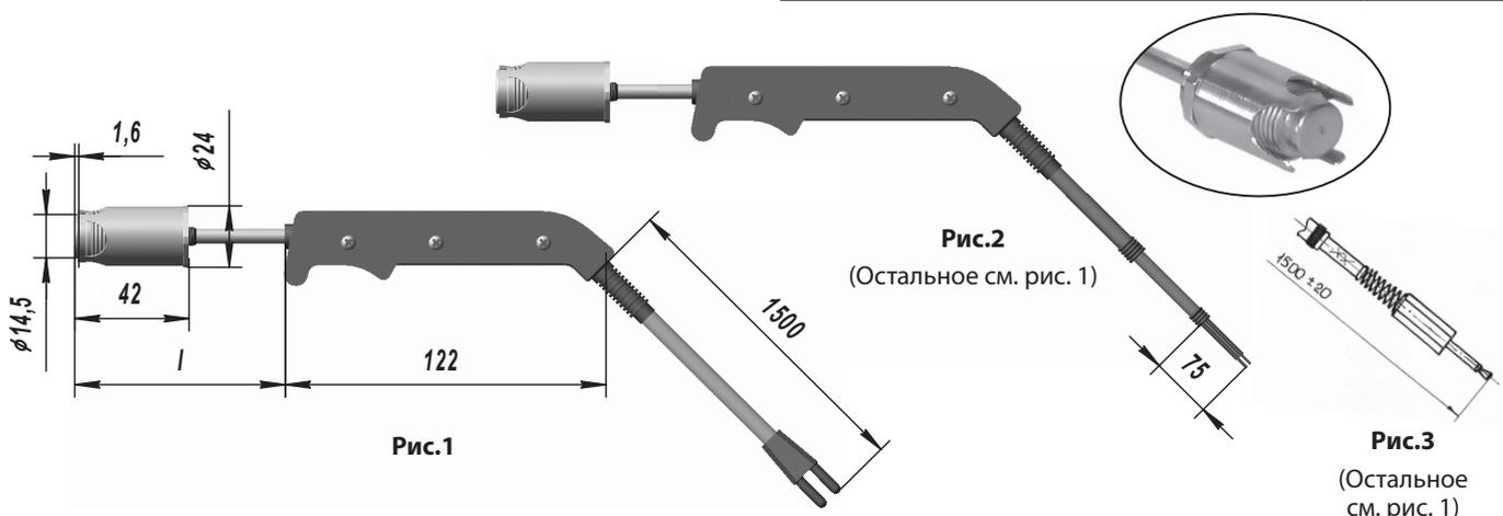
**ПОВЕРХНОСТНЫЕ ТЕРМОЭЛЕКТРИЧЕСКИЕ ПРЕОБРАЗОВАТЕЛИ (СИЛЬФОННЫЕ) ТХА 9911 ТХК 9911**
