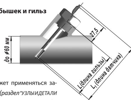
Для установки датчика может применяться защитная гильза ДДШ 6 236 009 (раздел "УЗЛЫ И ДЕТАЛИ ДЛЯ РЕМОНТА И МОНТАЖА ДАТЧИКОВ ТЕМПЕРАТУРЫ")
