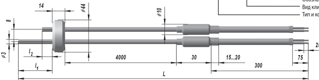
**КАБЕЛЬНЫЙ ЛИНЗОВЫЙ ПРЕОБРАЗОВАТЕЛЬ ТЕРМОЭЛЕКТРИЧЕСКИЙ ТХК 9902**
