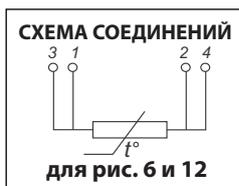
Рис.1 ТСП 9204 : Схема 4
