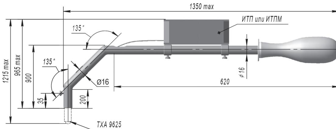
Рис.2 (приспособление для крепления термопреобразователя и измерителя температуры)
